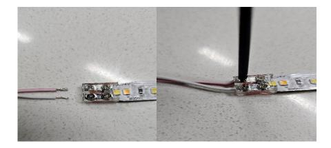
9. **Retirez délicatement le papier protecteur** au dos du ruban et du connecteur à l'aide d'un tournevis plat ou de ciseaux.
